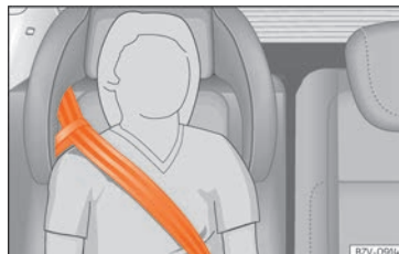
Abb. 35 Integrierter Kindersitz: Gurtbandverlauf mit Gurtführungsschleufe.
