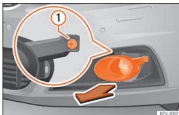
Abb. 66 Im Stoßfänger vorn rechts: Ausbau der Scheinwerfer.
