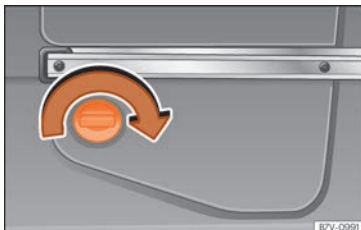
Abb. 283 Im Gepäckraum hinten links: AdBlue-Tank, hinter einer Abdeckung.
