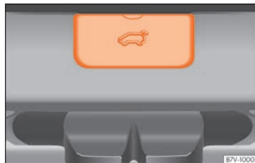
Abb. 107 Ausschnitt Gepäckraum: Zugang zur Notentriegelung.
