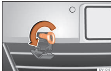
Abb. 56 Im Stoßfänger vorn rechts: Abschleppöse einschrauben.
