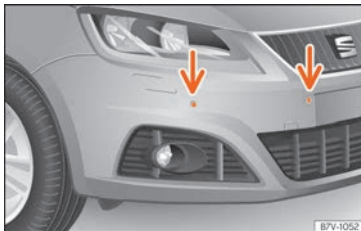
Abb. 272 Sensoren der Parkdistanzkontrolle vorn im Stoßfänger.
