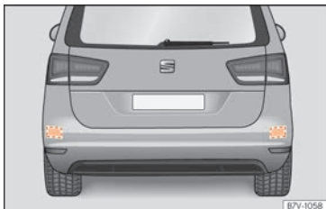
Abb. 247 Heckansicht des Fahrzeugs: Bereiche der Radarsensoren.
