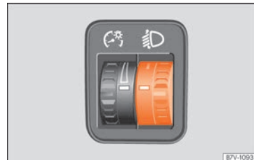
Abb. 118 Neben dem Lenkrad: Regler für die Leuchtweitenregulierung.
