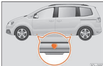
Abb. 47 Aufnahmepunkte für den Wagenheber.
