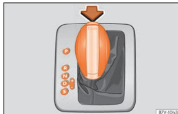
Abb. 238 Wählhebel des automatischen Getriebes mit Sperrtaste (Pfeil).
