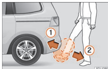
Abb. 106 Heckklappe mit sensorgesteuerter Öffnung (Easy Open).
