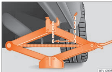
Abb. 48 Wagenheber hinten an der linken Fahrzeugseite angesetzt.
