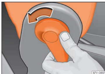
Abb. 139 Klappbare Beifahrersitzlehne entriegeln.
