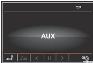
Abb. 210 Medien-Betrieb: Externe Audioquelle über Buchse AUX-IN angeschlossen.
