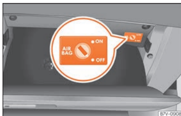
Abb. 18 Im Handschuhfach, auf der Beifahrerseite: Schlüsselschalter zum Aktivieren und Deaktivieren des Beifahrer-Frontairbags.
