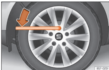
Abb. 45 Radwechsel: Radschrauben lockern.
