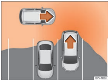
Abb. 265 Schematische Abbildung des Ausparkassistenten: Überwacher Bereich des ausparkenden Fahrzeugs.
