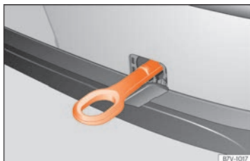
Abb. 57 Auf der rechten Seite des hinteren Stoßfängers: eingeschraubte Abschleppöse.
