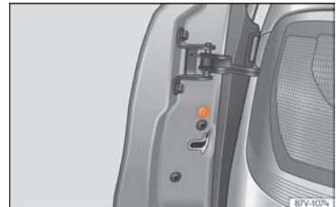
Abb. 96 Im vorderen Teil der Schiebetür: Notverriegelung, durch eine Gummidichtung verdeckt.
