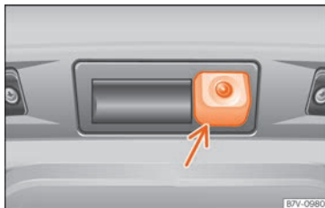
Abb. 249 Im Stoßfänger hinten: Einbauort der Kamera des Rückfahrassistenten.
