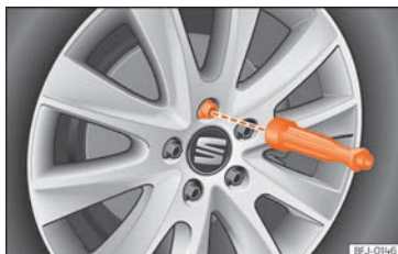
Abb. 49 Radwechsel: Radschrauben mit dem Schraubendrehergriff herausdrehen.
