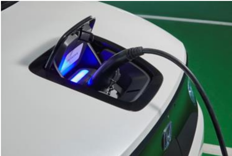
Abbildung 5: Position der Ladebuchse des Honda e in der Front mittig
